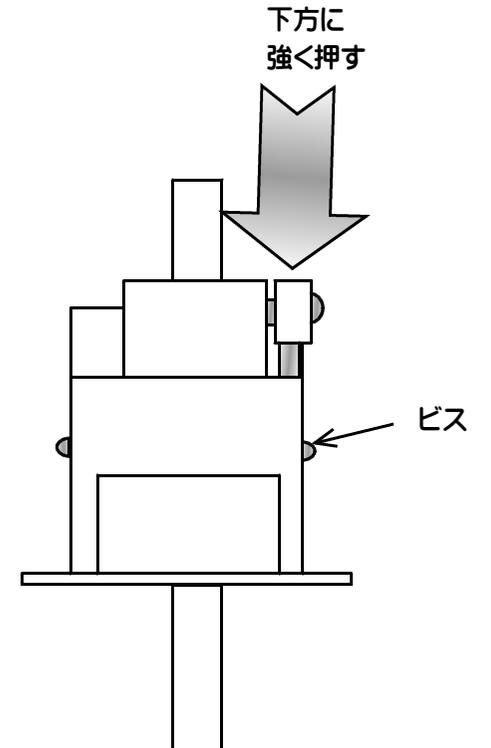
④ローラー部を下方に強く押しながら右側のビスを締めて完成
