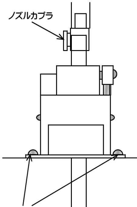
①固定ビスを取り、ノズルカブラを外しノズルアツシを手元へ引き出す
