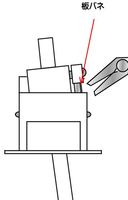
③斜めになった状態でラジオペンチのような先端が細いもので板バネを取り替える
