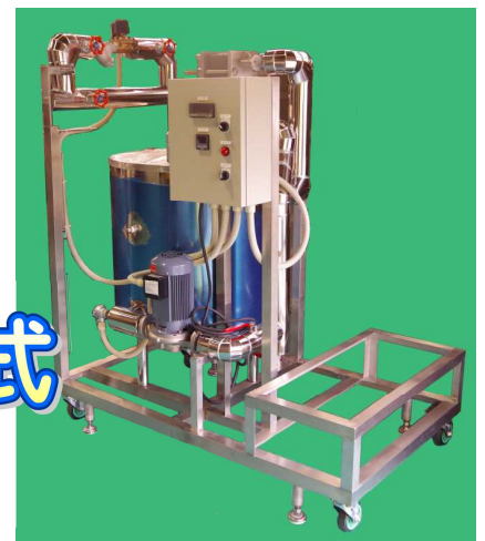
BHP-600 600L/時/10°C→70°C 三相200V 0.4kw 巾1500×奥行850×高さ1300
