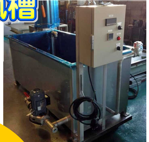
BK-1600 水槽1600巾×750奥行 高さ400 水量480L 三相200V0.4kw
