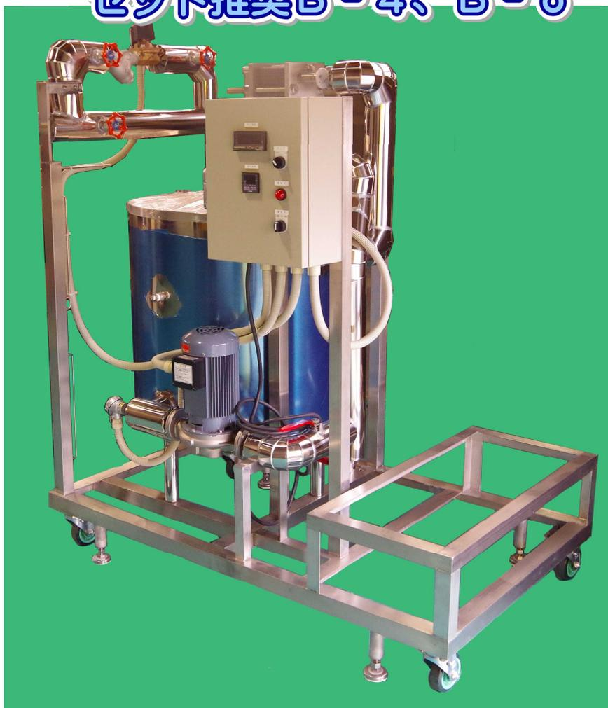
簡易充填機『びん太』専用のプレート式熱交換機が登場しました。コンパクトにまとめられた本体には簡易充填機びん太の6本取りまで取付られる台をご用意しました。スイッチはポンプと温調の2個だけで、初心者でも理解しやすい機器となっています。プレートの材質はチタンで、温水と清酒の温度がほぼ同じなので、瓶詰めラインが停止しても、清酒の温度の上昇がありません。立ち上がりも早く、残酒も少ない『びん太プレートBHP-600』を是非ご使用下さい。
